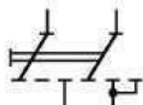
Interruptor múltiple (operado manualmente)
